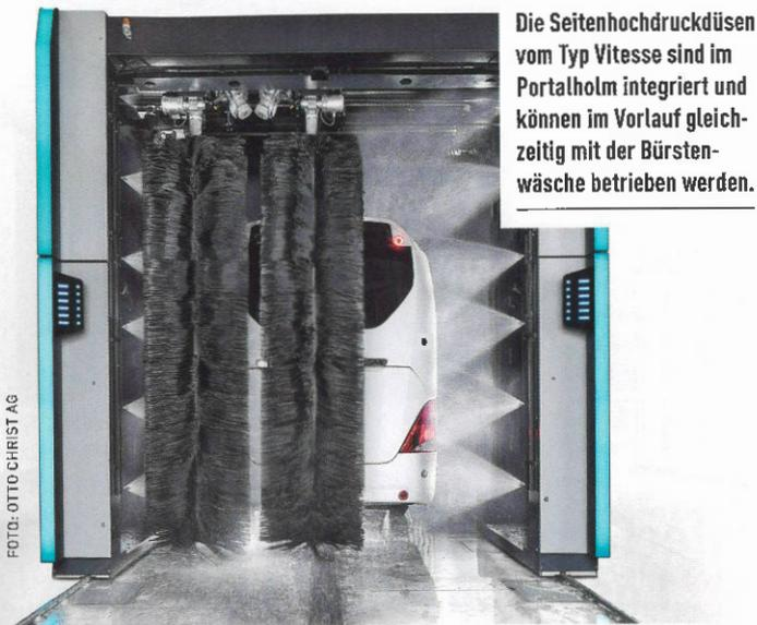
Die Seitenhochdruckdüsen vom Typ Vitesse sind im Portalholm integriert und können im Vorlauf gleichzeitig mit der Bürstenwäsche betrieben werden.
